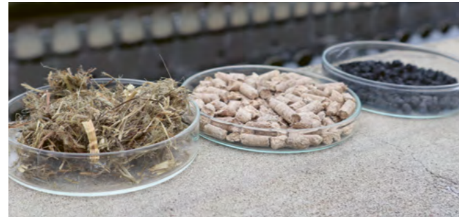
Der Weg zur biogenen Aktivkohle: Links grasartiges Landschaftspflegematerial, in der Mitte daraus produzierte Pellets, die über Pyrolyse und Aktivierung zur biogenen Aktivkohle (rechts) verarbeitet wurden.
