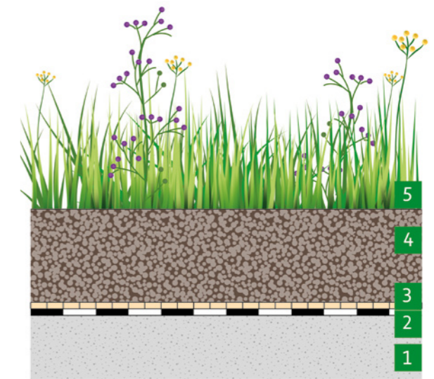
Abb. 3: Einschichtiger Gründachaufbau. Quelle: BuGG
