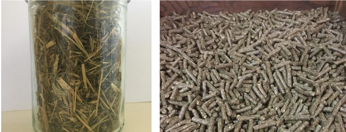
Abbildung 7: Verarbeitung von IFBB-Presskuchen für die anschließende Pyrolyse und Aktivierung
