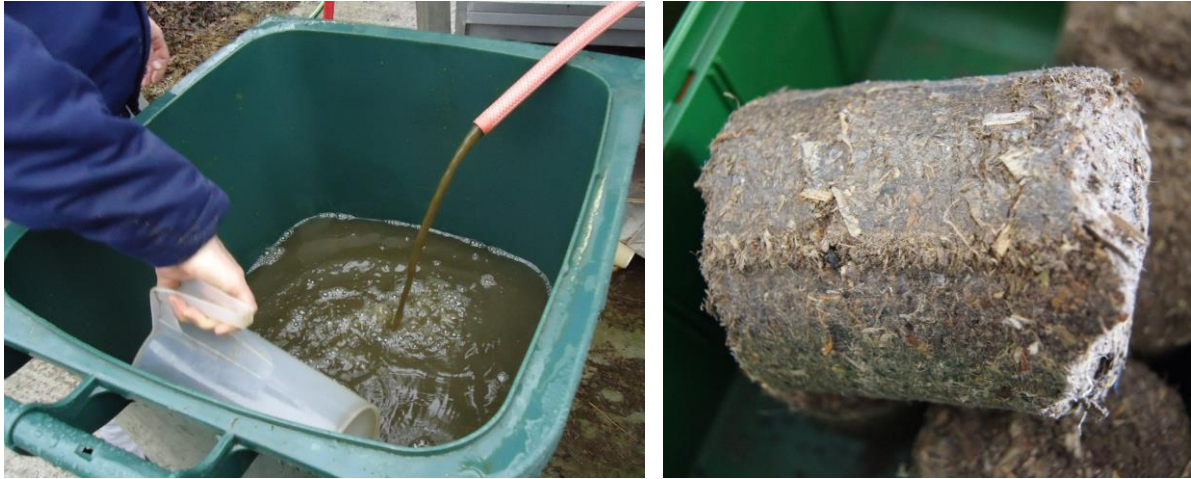
Abbildung 6: Presssaft (links) und Presskuchenbrikett (rechts) nach mechanischer Entwässerung, Trocknung und Brikettierung im IFBB-Technikkonzept
