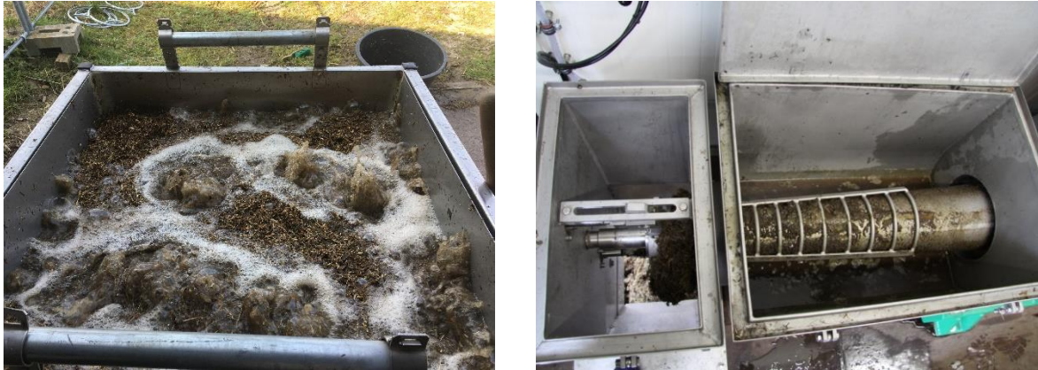
Abbildung 4: Hydrothermale Konditionierung (links) und mechanische Entwässerung (rechts) von Restbiomassen im IFBB-Technikkonzept
